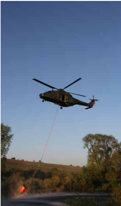
Der starke Rotorabwind erschwert die schnelle und vollständige Befüllung.
